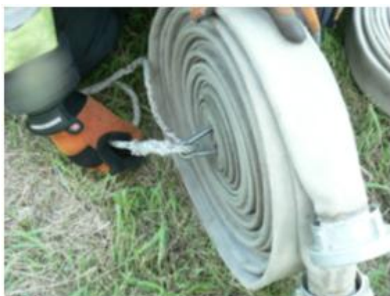
11-12. kép: tekercstömlő megkötése
