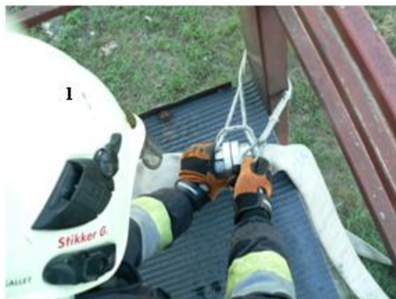
98. kép: tömlő kikötése
