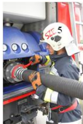
106-107. kép: szívótömlő csatlakoztatása
