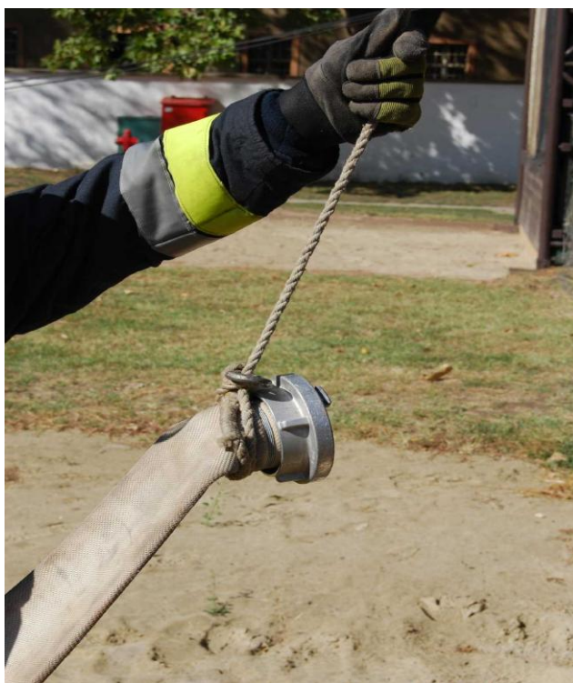
92-94. kép: sugár szerelése magasba, tömlőfelhúzással
