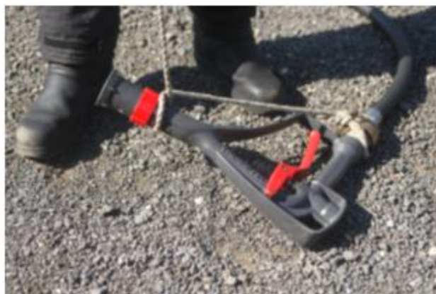
34-39. kép: gyorsbeavatkozó sugár megkötése felhúzáshoz
