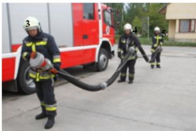
106-107. kép: szívótömlő csatlakoztatása
