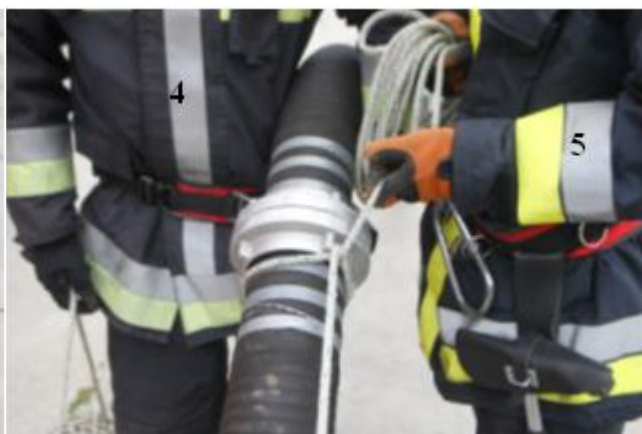
105. kép: szívótömlő megkötése
