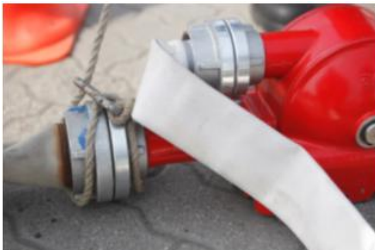
40-41. kép: mélyszívó megkötése
