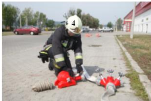
121. kép: „C” tömlő csatlakoztatása
