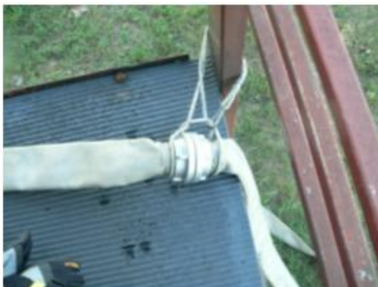
10. kép: tömlő kikötése
