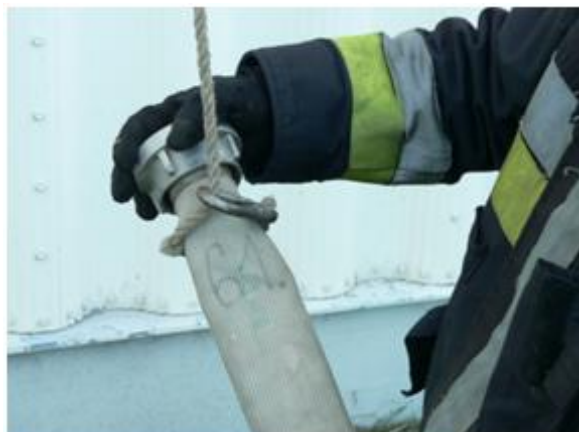
97. kép: tömlő megkötése
