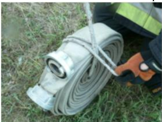
11-12. kép: tekercstömlő megkötése
