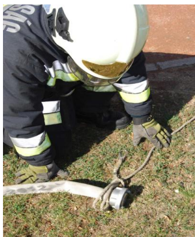
26-31. kép: tömlővezeték megkötése felhúzáshoz
