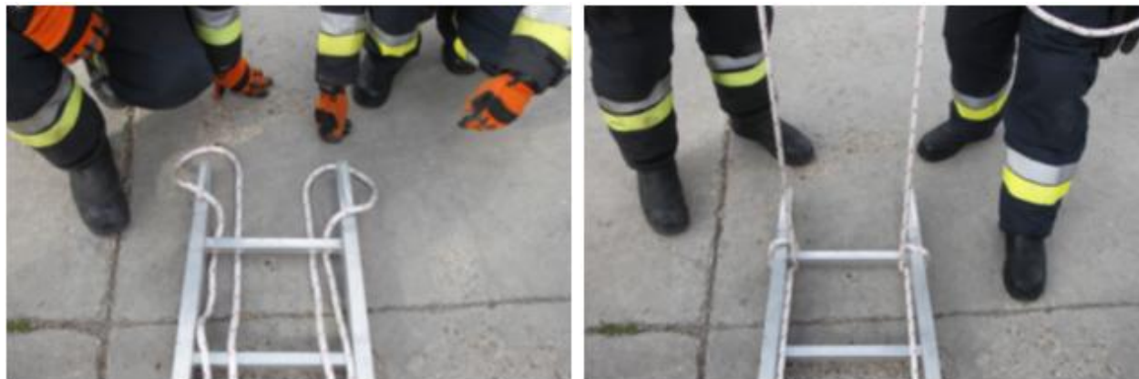
135-136. kép: létre megkötése
