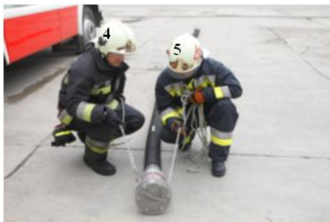
104. kép: kút- és szelepkötél megkötése
