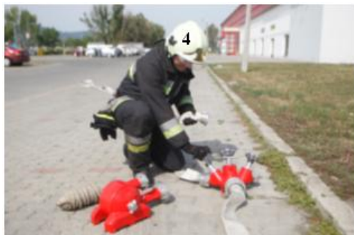
120. kép: osztó kinyitása
