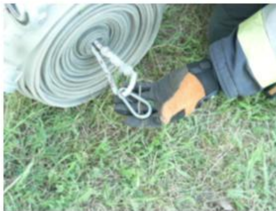
11-12. kép: tekercstömlő megkötése
