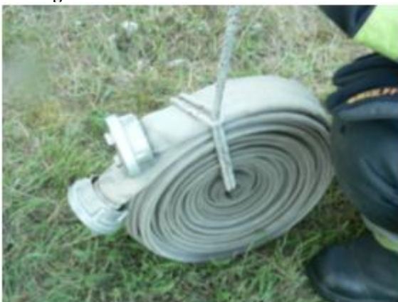
11-12. kép: tekercstömlő megkötése
